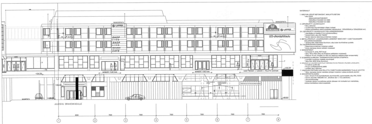
Kuva 59. Julkisivu Brahenkadulle eli edustatorille vuoden 2014 luvassa. Ikkunaelementeissä uusittiin profiilipellytykset valkeiksi läpivärjättyiksi sileiksi julkisivulevyiksi. (Lappeenrannan kaupunki/ Rakennusvalvonnan sähköinen arkisto)
