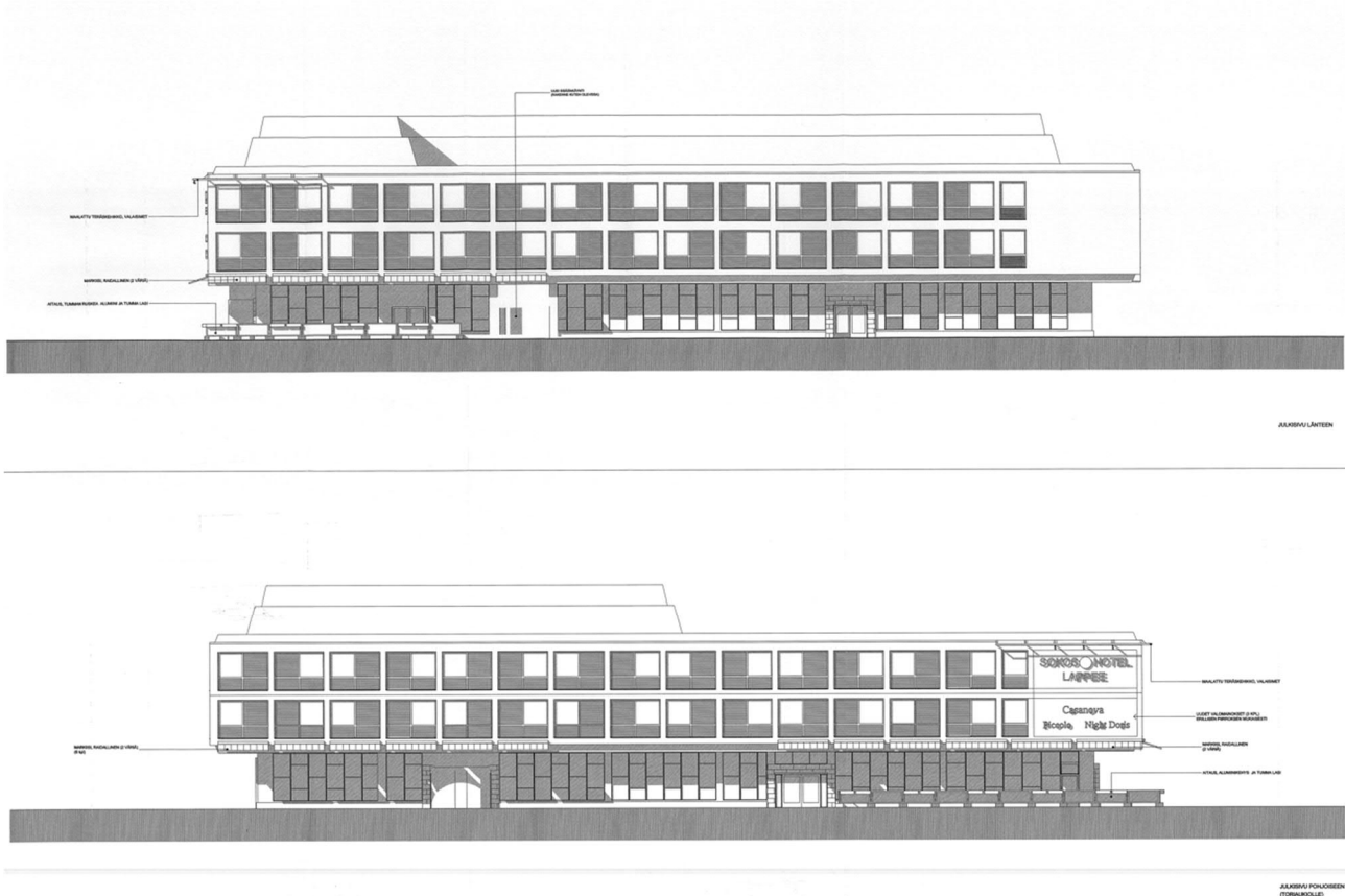
Kuva 49. Julkisivuihin tuli pieniä muutoksia vuonna 2002, kun uuden kahvilan terassille asennettiin markiisit, aitaus, valaisimia, uusittiin julkisivuvalaistuksia sekä asennettiin uusia valomainoksia. Lisäksi tehtiin uusi sisäänkäynti Kirkkokadun puolelta ravintolatiloihin. Muutokset koskivat toritason ensimmäistä kerrosta. (Lappeenrannan kaupunki/ rakennusvalvonnan sähköinen arkisto)
