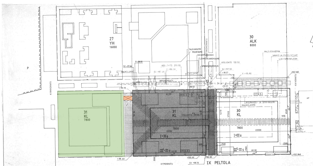
Kuva 37. Kuvassa Kauppakeskus Iso-Kristiinan asemapiirustus vuoden 1987 luvassa. Kauppakeskuksen länsipään kolmannen kerroksen toimistotilat muutettiin hotellihuoneiksi, joihin pääsi hotellin kolmanteen kerrokseen sijoitetun kulkusillan kautta. Kuvan selkiyttämiseksi Hotelli Lappee on esitetty vihreällä värillä ja kauppakeskuksen muutososa harmaalla värikentällä. Yhdysputki on merkitty oranssilla. (Lappeenrannan kaupunki/ rakennusvalvonnan sähköinen arkisto)
